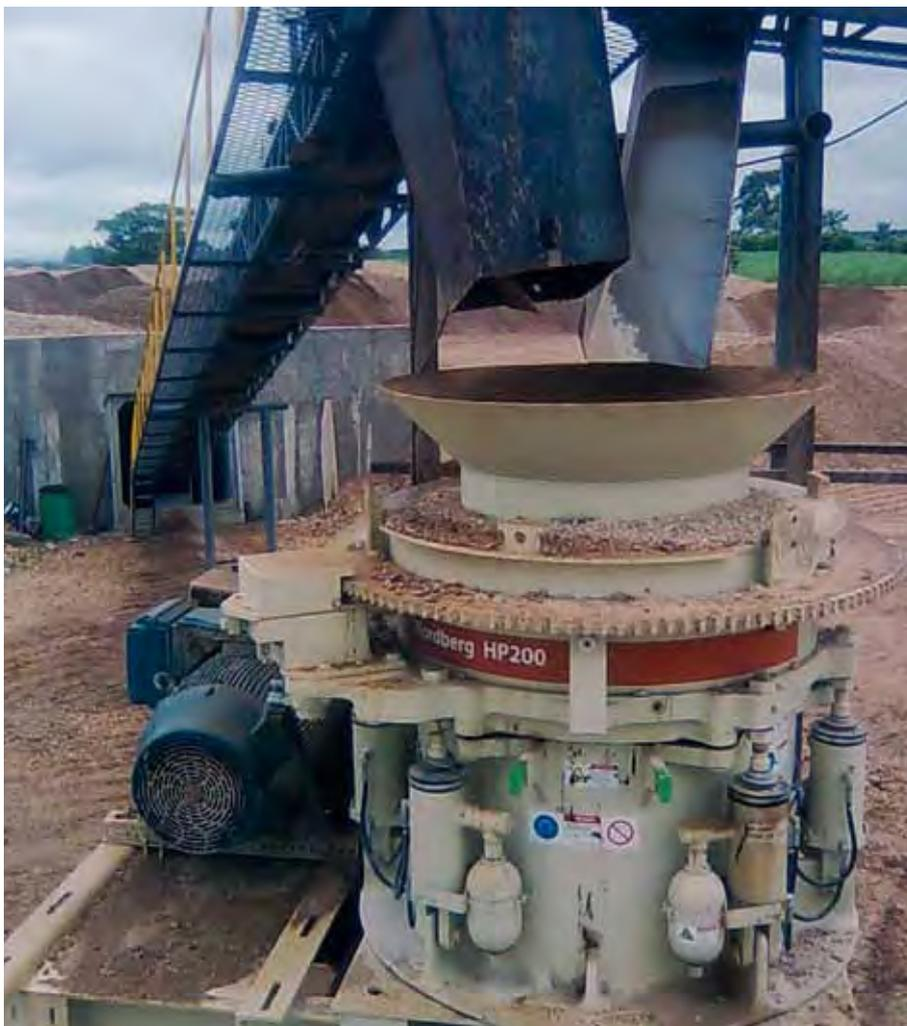
A britagem do seixo pelo HP200 produz areias com diferentes granulometrias que, após o peneiramento, são utilizadas para diversas aplicações especiais
