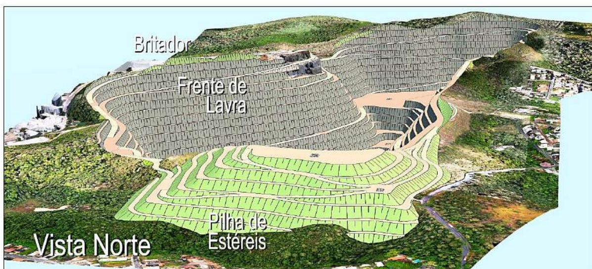
Vistas de frente e de cima e mais em detalhe da cava final e pilha de estéril.
